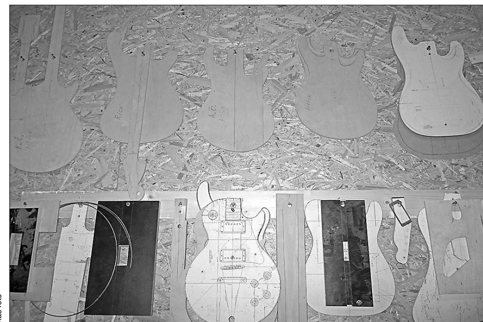
«AttAck» ģitāru darbnīcā var redzēt sagataves, kas nepieciešamas, lai uztaisītu labu ģitāru. Kā stāsta pats ģitāru meistars, tad viena ģitāra top apmēram mēneša laikā, un ir vajadzīgas aptuveni desmit atšķirīgas dažādu ģitāras detaļu sagataves, lai taptu kvalitatīvs mūzikas instruments
